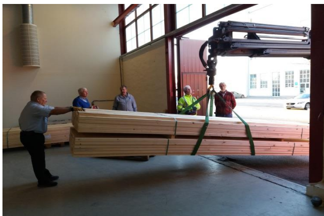
Virket lastas in. Totalt 2 ton.
